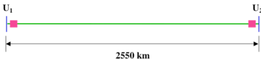
Fig. 2 – Representação esquemática de uma linha trifásica de 800 kV, 2550 km, com potência característica P_c = 4,8 GW, sem compensação reativa, manobrada de uma extremidade (toda a linha). A sobretensão sustentada num terminal (aberto) é 1,014 pu (referida à tensão no outro terminal).
