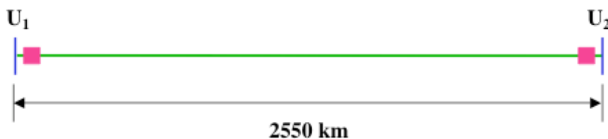
Fig. 7 – Representação esquemática de uma linha trifásica de 1000 kV, 2550 km, com potência característica P_c = 8,6 GW, sem compensação reativa, manobrada de uma extremidade (toda a linha). A sobretensão sustentada num terminal (aberto) é 1,017 pu (referida à tensão no outro terminal).
